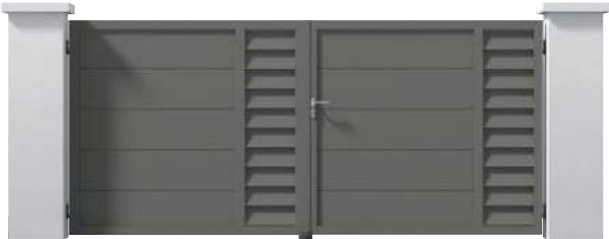
Portail battant composition 3, remplissage principale lames 300 x 25 mm, remplissage secondaire lames persiennes 150 x 15 mm
